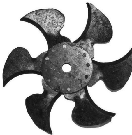
Рис. 1.3. Ротаційно-лопатевий робочий орган [2, 7].
