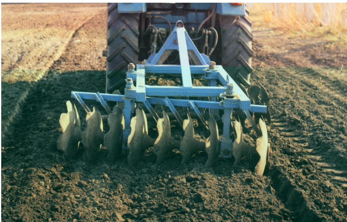
Рис. 3.4. Характер обробітку ґрунту стандартними робочими органами (вирізними дисками європейського типу)
