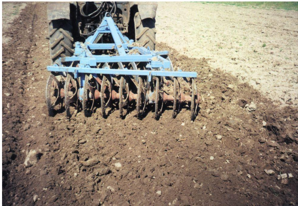
Рис 3.3. Характер обробітку ґрунту кільцевими робочими органами
