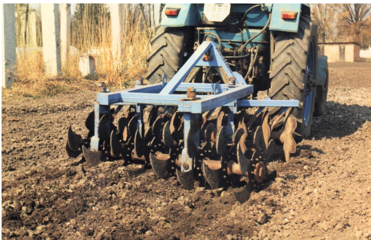
Рис. 3.5. Характер обробітку ґрунту ротаційно-лопатевими робочими органами
