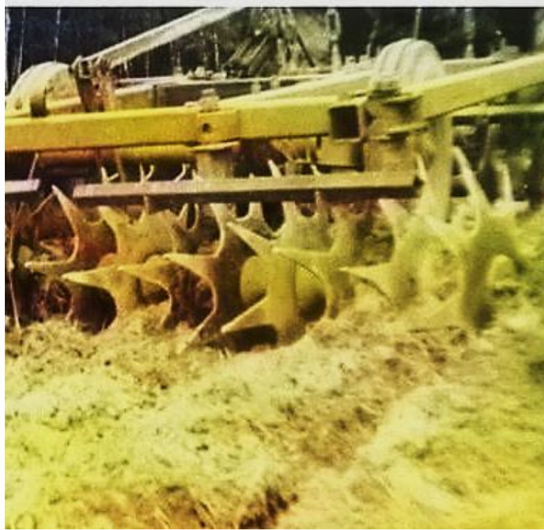
Рис. 3.2. Характер обробітку ґрунту зірчастими робочими органами
