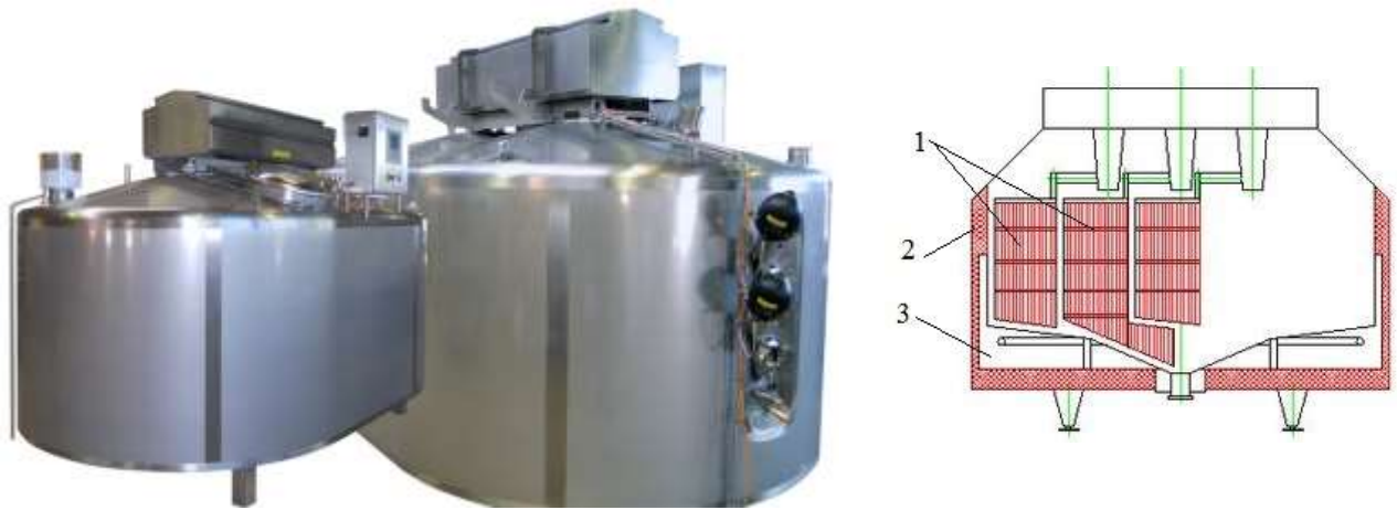
Рис. 1.3. Виготовлювач сирний Я5-ОСЖ: 1 – комбінований робочий орган; 2 – термоізоляція; 3 – нагрівальна сорочка [16, 17].
