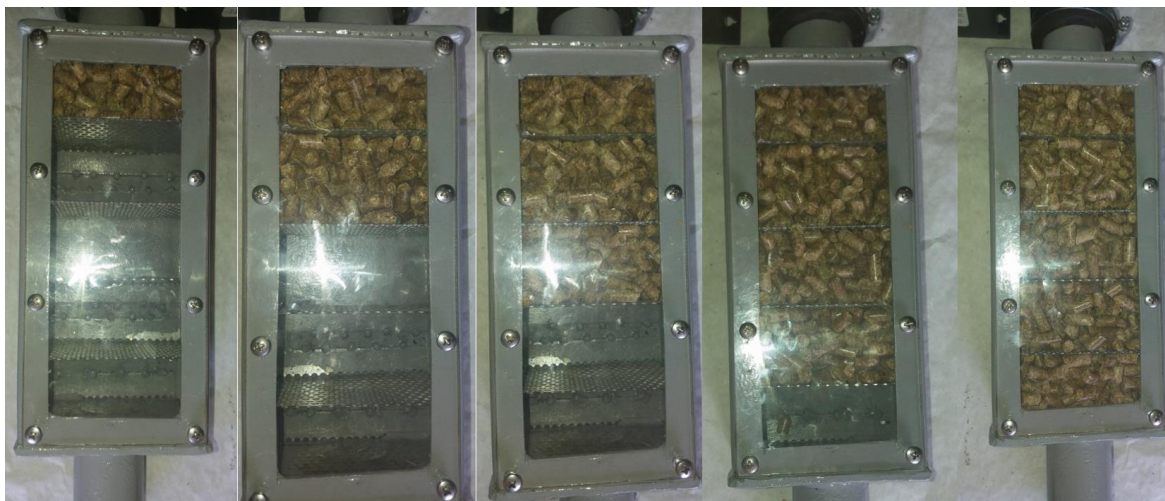
Рис. 2.2. Схема етапів завантаження компонента паливними гранулами
