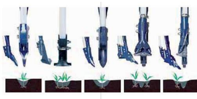
Рис. 1.3. Змінні наральники сошників анкерного типу сівалок Махім (виробництва Morris) (вгорі), схема розподілу рослин(знизу)
