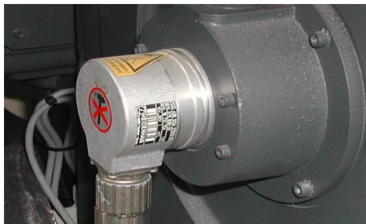
Рис. 2.5. Фото встановленого датчика крутного моменту.
