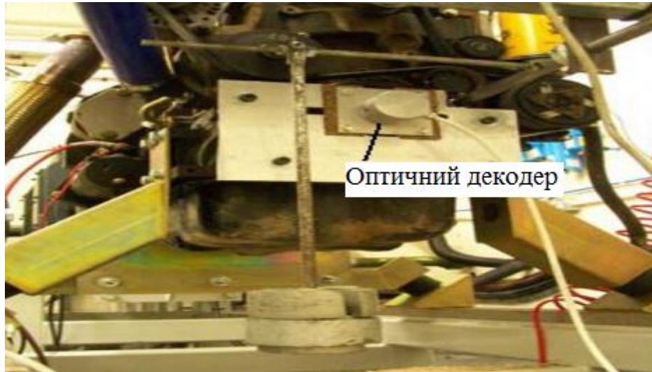
Рис. 2.3. Фото встановленого оптичного декодера на дизельний двигун Встановлений оптичний кодер дозволяє почати збір даних з абсолютно однаковим положенням кута кривошипа у кожному циклі.
