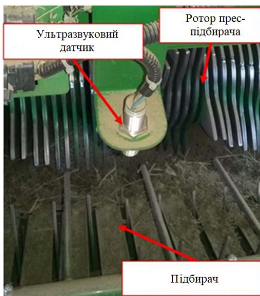
Рис. 2.3. Ультразвуковий датчик для визначення потоку рослинної маси
