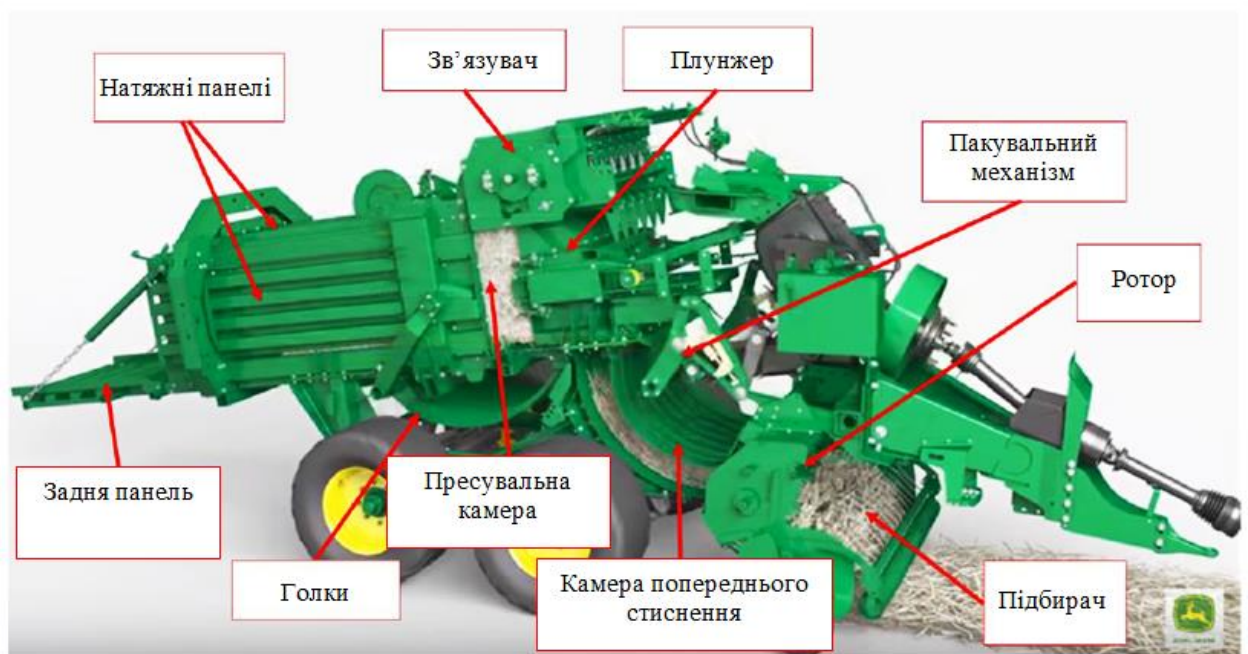
Рис. 1.1. Основні частини великого квадратного прес-підбирача John Deere
