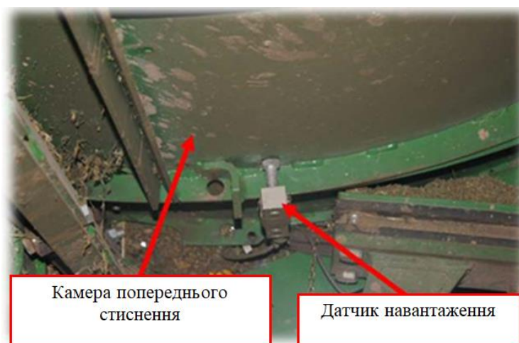
Рис. 2.2. Датчик зусилля лотка встановлений поряд з передньою частиною лотка зі знятими штифтами лотка
