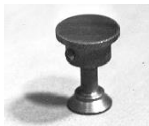
Рис. 2.3. Штифтовий чавунний зразок для визначення міцності зчеплення покриття
