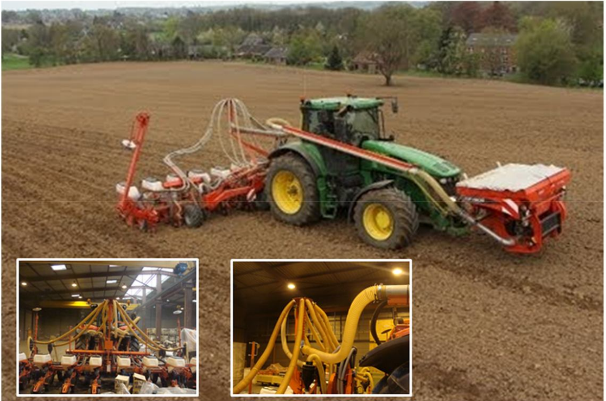
Рис. 2.1. 8-рядна точна сівалка Kuhn Maxima 2 TI у поєднанні з переднім бункером Kuhn TF-1500.
