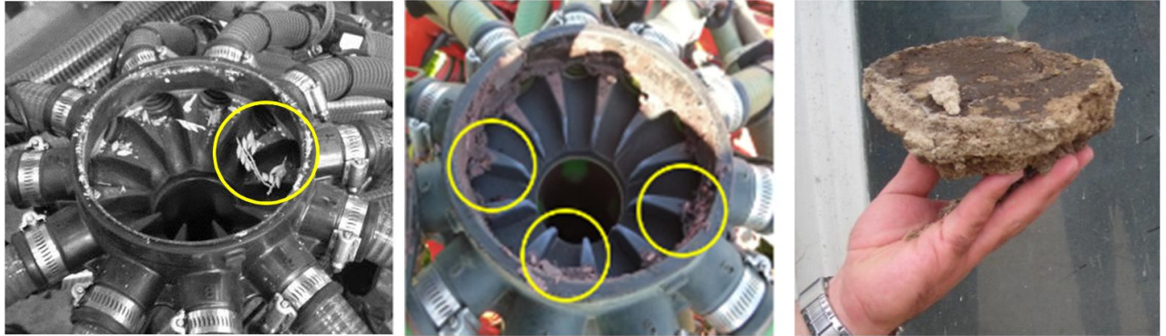
Рис. 3.4. Забиття виходів розподільника пневматичних сівалок.
