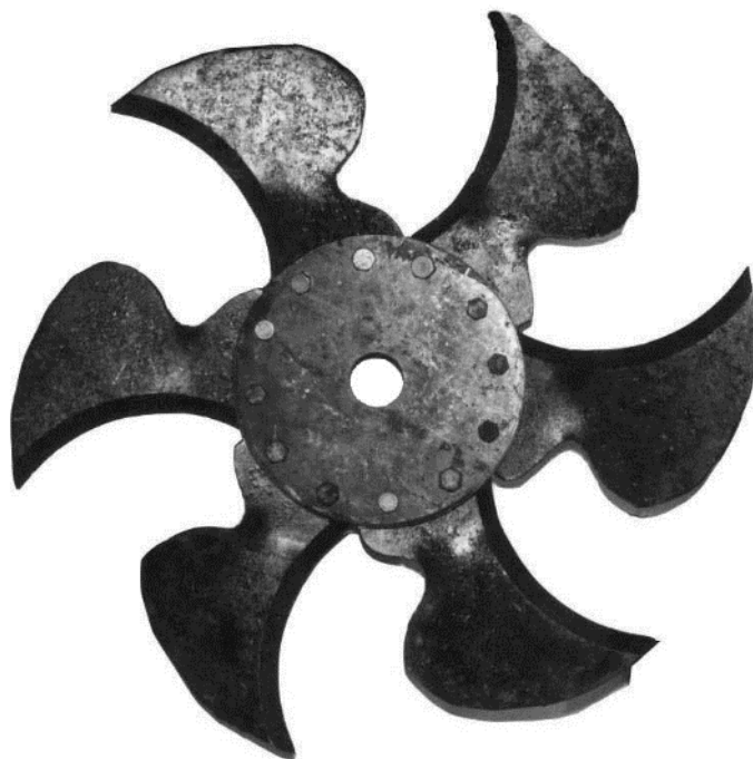
Рис. 3.7. Робочий орган дискового ножа: а) геометричні параметри, б) загальний вигляд прототипу
