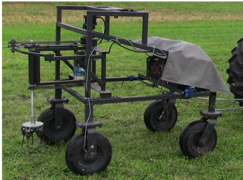
Рис. 2.6. Прототип з удосконаленим механізмом приводу прополювача.
