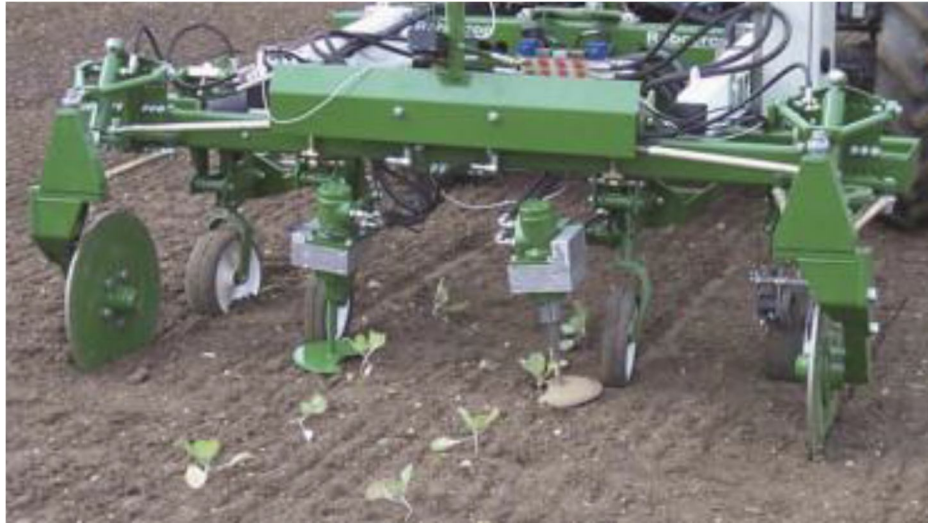
Рис. 1.1. Автоматизована система знищення бур'янів у міжрядковому просторі (робочі органи – напівкруглі диски)
