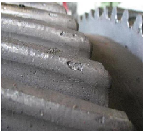
Рис. 1.1. Спрацювання зубів зубчатої передачі внаслідок [13–15]: a – викришування; б – виламування
