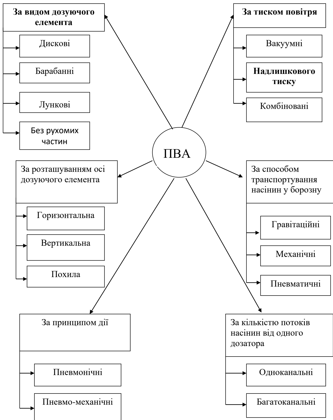
Рис. 1.1. Класифікація пневматичних висівних апаратів
