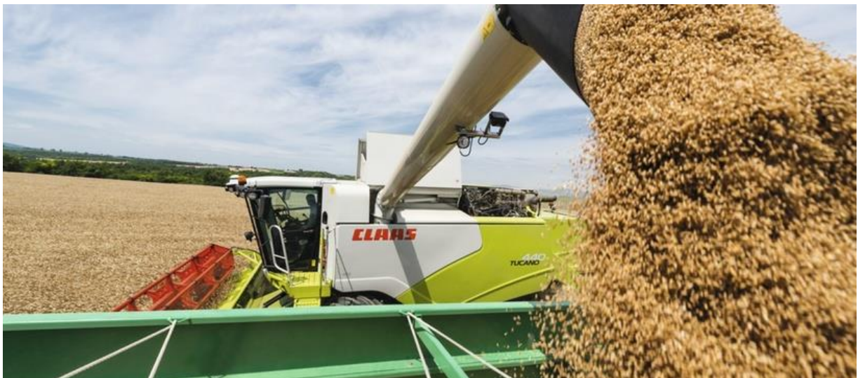
Рис. 3.6. Зерновий бункер та система вивантаження зерна [26].
