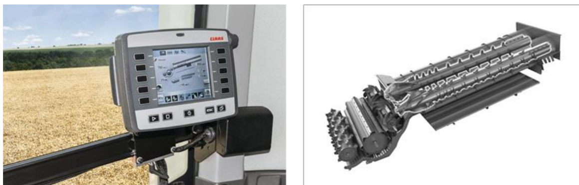
Рис. 1.3. Система автоматичного регулювання процесів сепарації та очищення.
