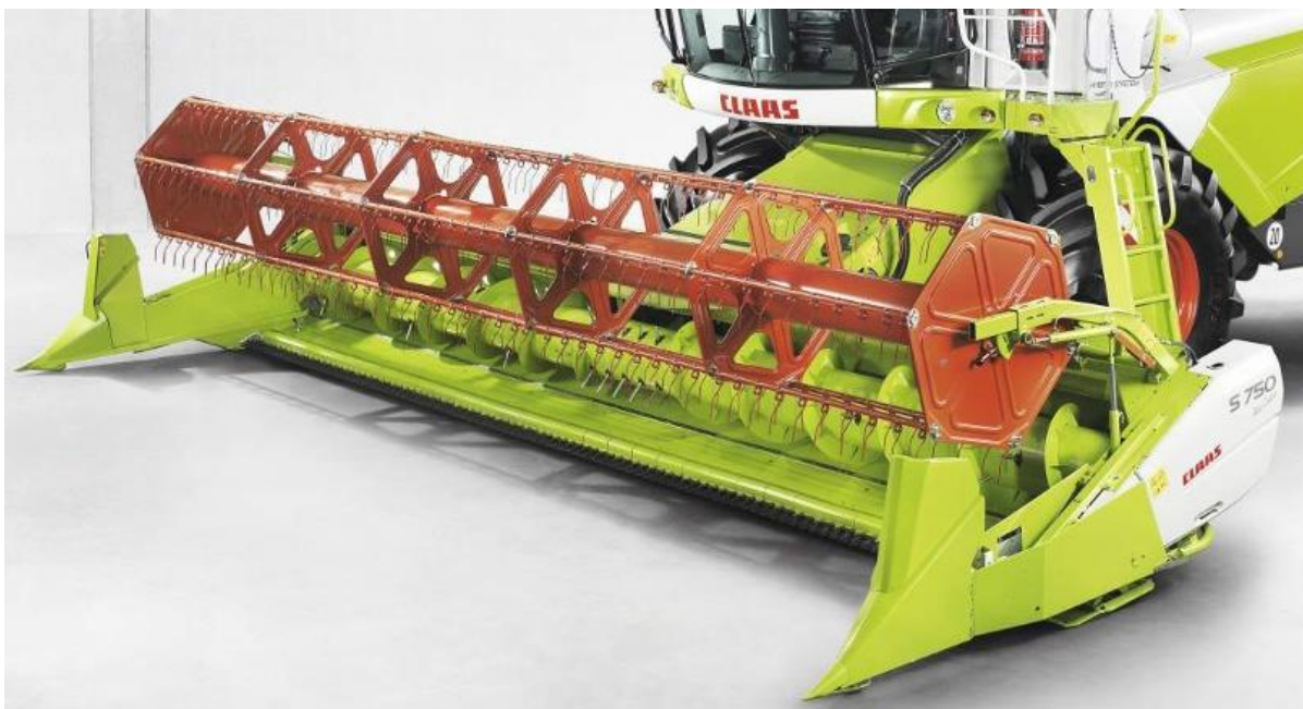
Рис. 3.2. Жатка зернозбирального комбайна для зернових сільськогосподарських культур.
