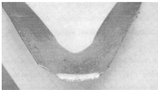
Рис. 3.9. Вид експериментальних лап після напрацювання 15-20 га
