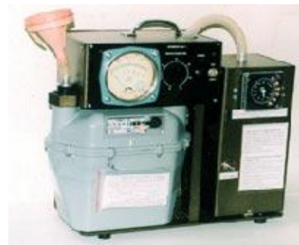
Рис.2.6. Аспіратор автоматичний одноканальний типу АВА-1
