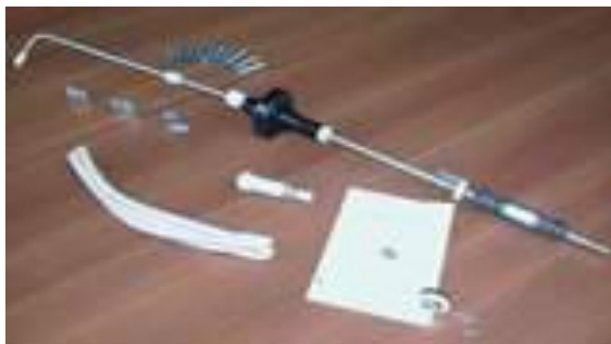
Рис. 2.5. Зонд для відбору проб на наявність пилу
