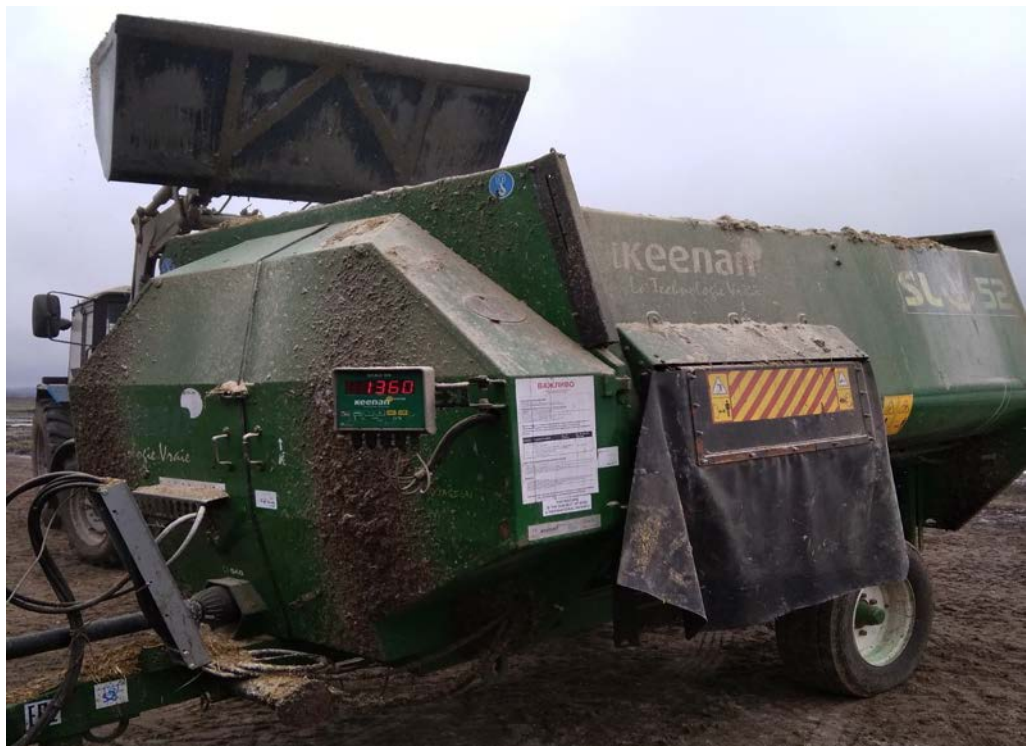
Рис. 2.7. Мобільний змішувач-роздавач кормів.
