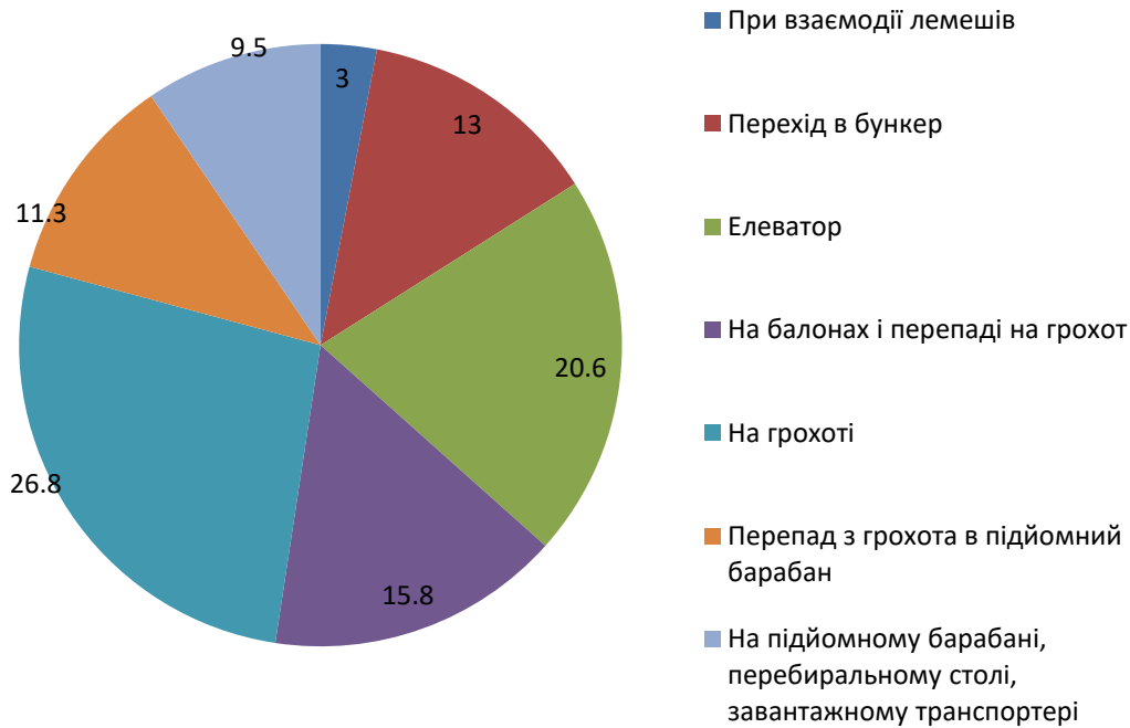
Рис. 1.1. Пошкоджуваність бульб картоплі робочими органами картоплезбирального комбайна (% від загальної кількості пошкоджень по вазі)
