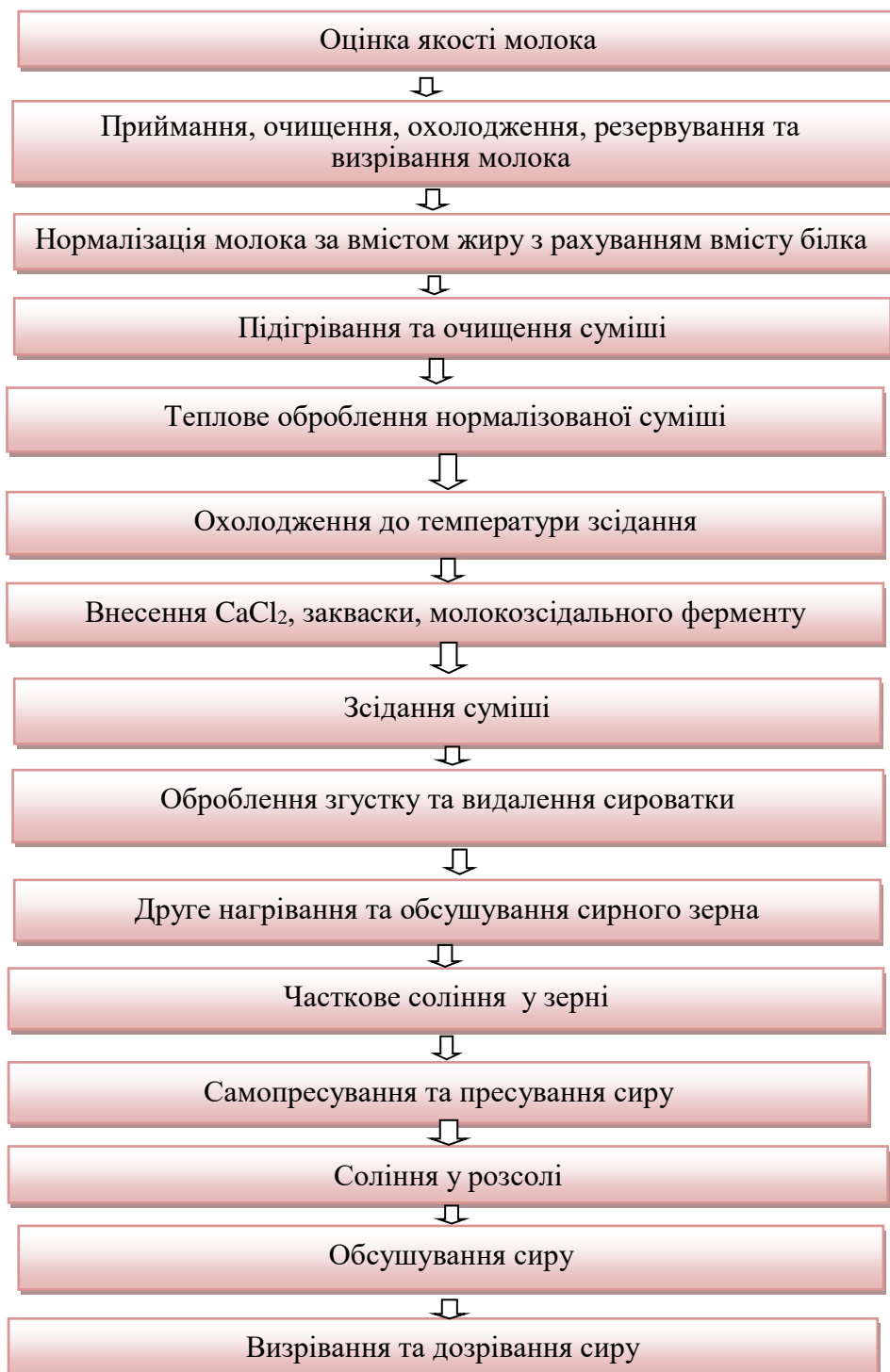
Рис. 3.1. Схема технологічного процесу виробництва твердих сирів.
