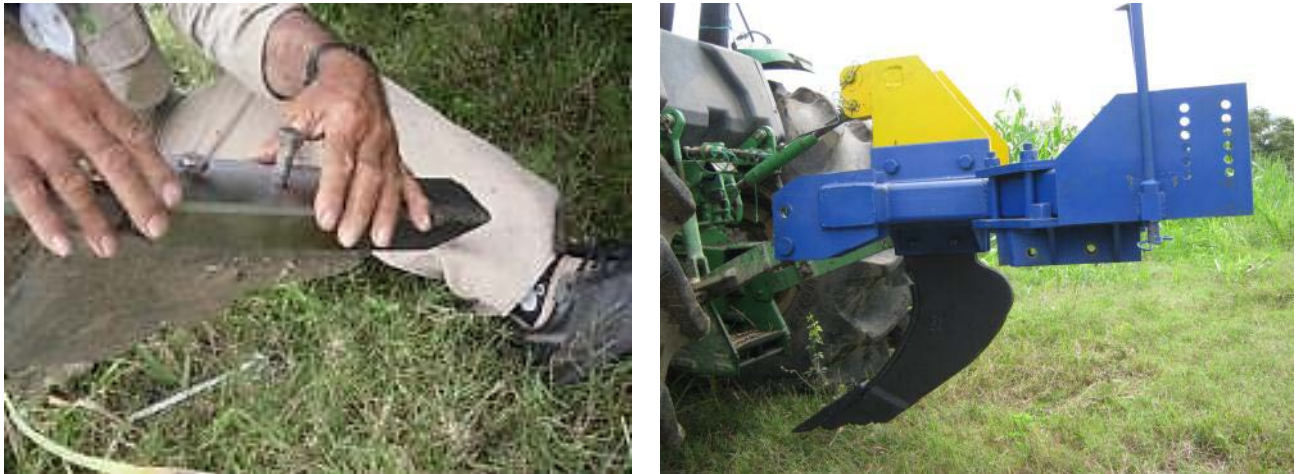
Рис. 2.3. Робочі органи глибокорозпушувача при встановленні на агрегат та під час експлуатації.
