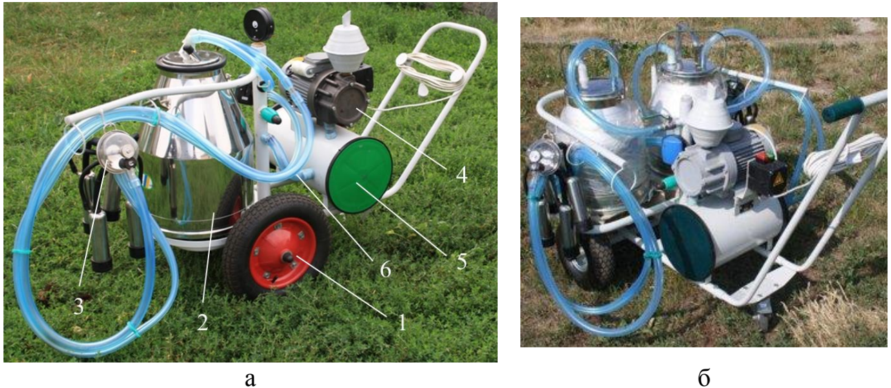
Рис. 1.3. Малогабаритна пересувна доїльна установка УІД-10 (а) та УІД-20 (б): 1 – візок; 2 – молочне відро; 3 – підвісна частина доїльного апарата; 4 – вакуумний насос; 5 – вакуумний балон; 6 – вакуум-провід.
