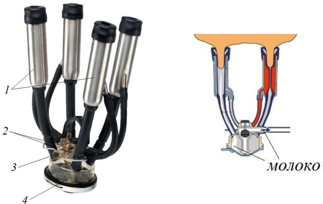
Рис. 1.2. Колектор Шведської фірми DeLaval MC-50: 1 – підвісна частина; 2 – повітряні патрубки з'єднання із другою камерою пульсатора; 3 – патрубок виведення молока; 4 – прозорий корпус [4, 8, 10]
