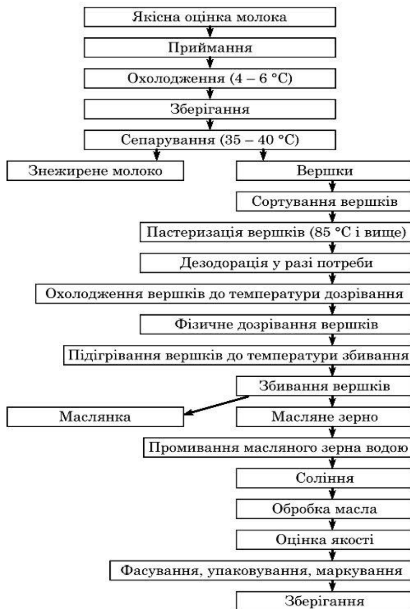
Рис. 3.2. Схема виробництва масла шляхом збивання вершків
