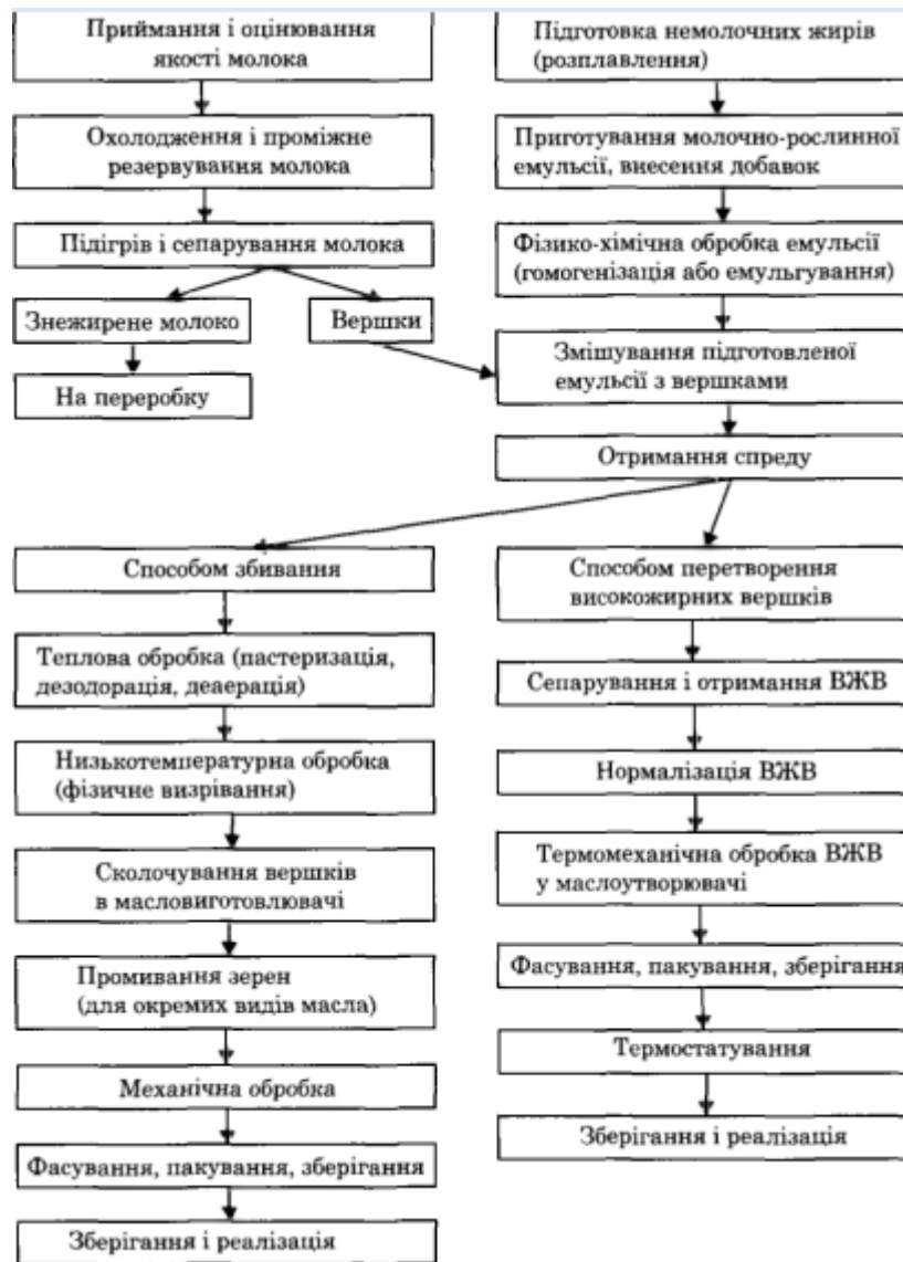
Рис. 3.3. Технологічна схема виробництва спредів
