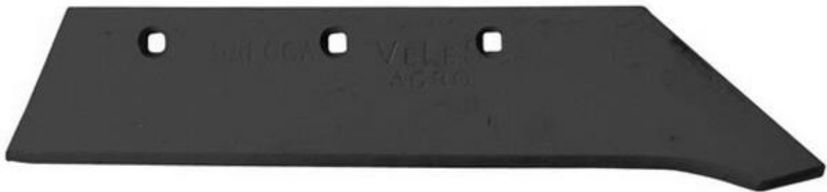
Рис. 3.1. Геометричні розміри (а) та загальний вигляд (б) леміша.
