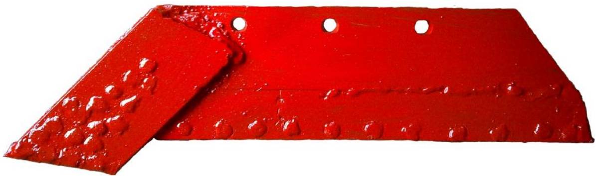
Рис. 3.3. Варіант точкового наплавлення.
