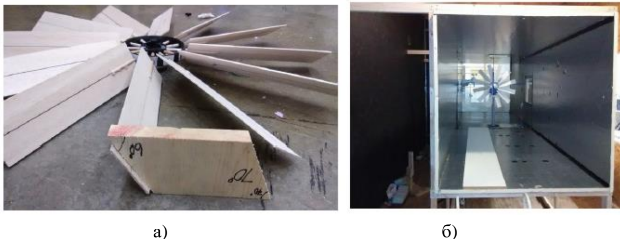
Рис. 3.4. Налаштування ротора (а) та випробування в аеродинамічній трубі (б)
