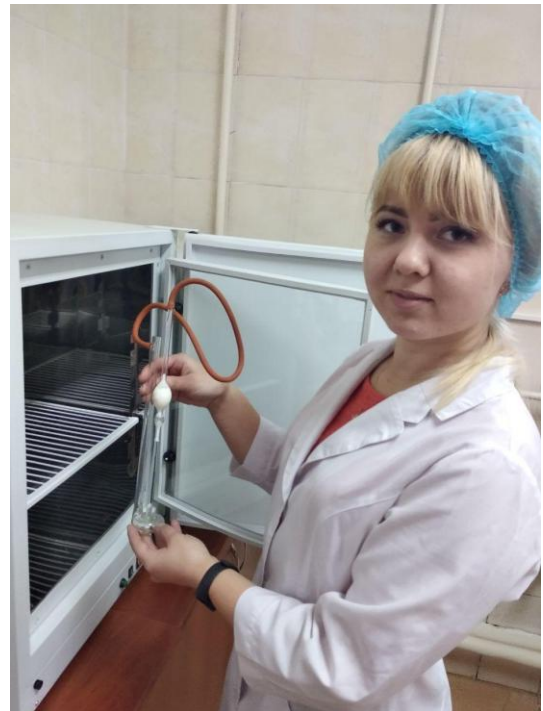
Рис. 11. Визначення умовної в'язкості у дослідних зразках
