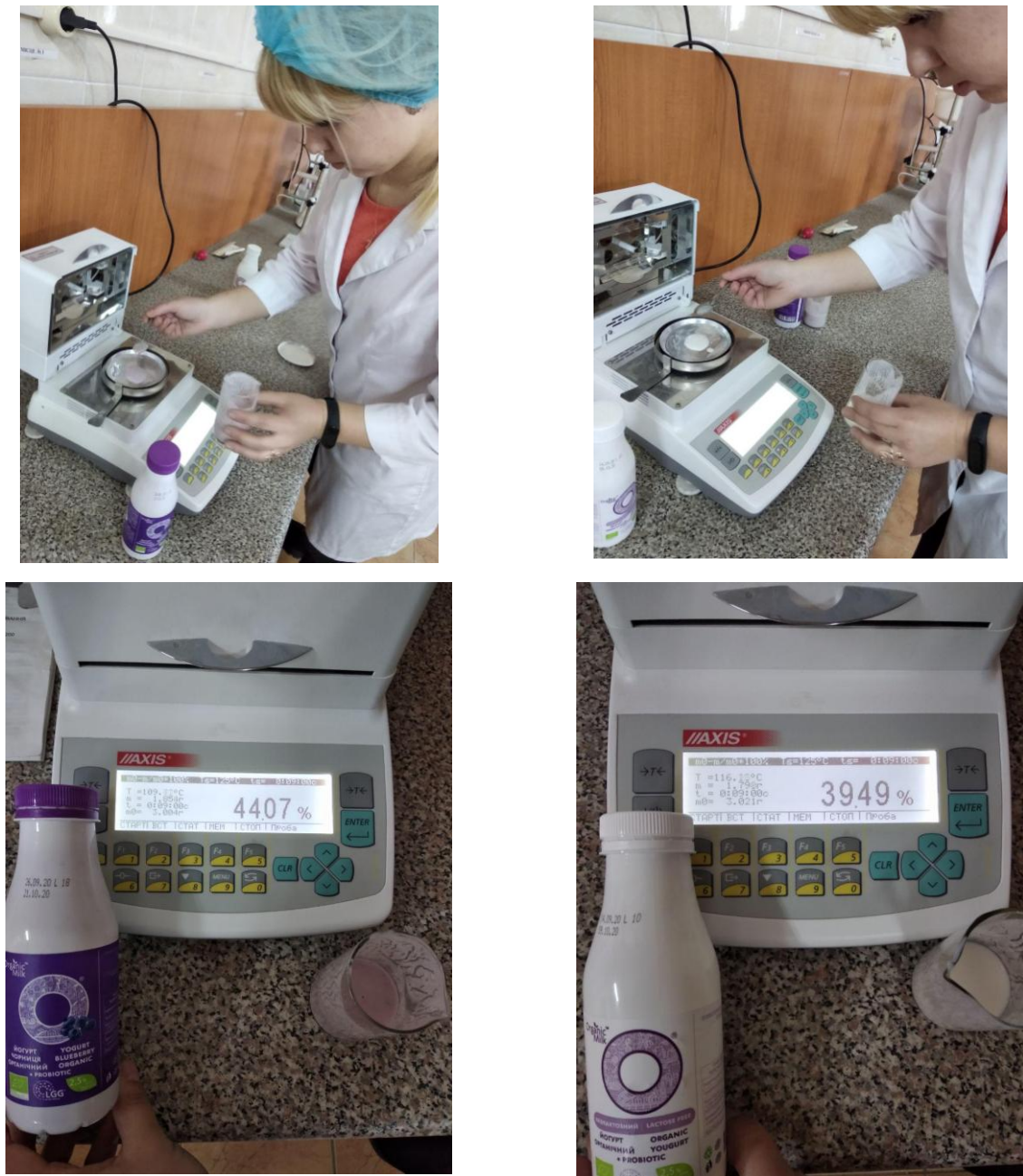
Рис. 12. Визначення вмісту вологи у дослідних зразках
