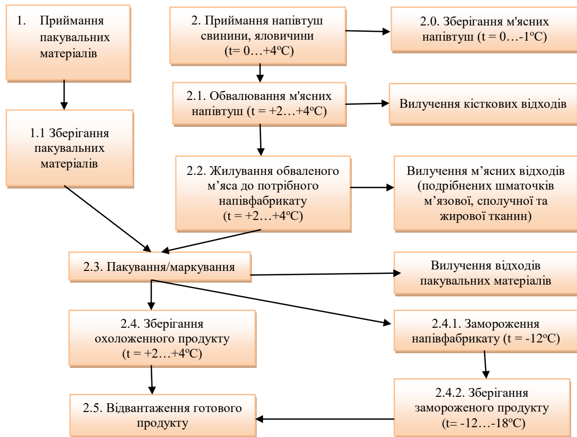
Рис. 3.1. Схема переробки сировини на підприємстві ТОВ Терещенко А. Г. «Ковбаси Черняхова»
