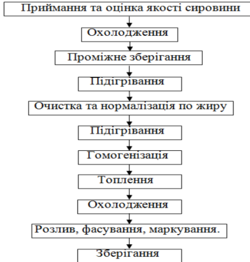
Рис. 3.3. Технологічна схема виробництва пряженого молока
