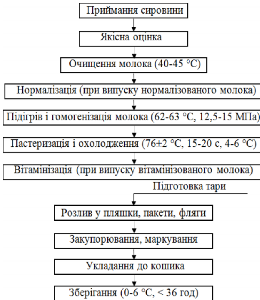
Рис. 3.2. Технологічна схема виробництва пастеризованого молока.
