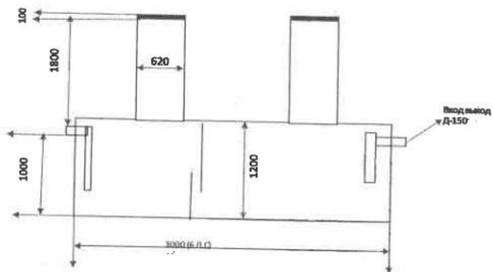
Рис. 2. Схема сепаратора жирів «Сток-С»
