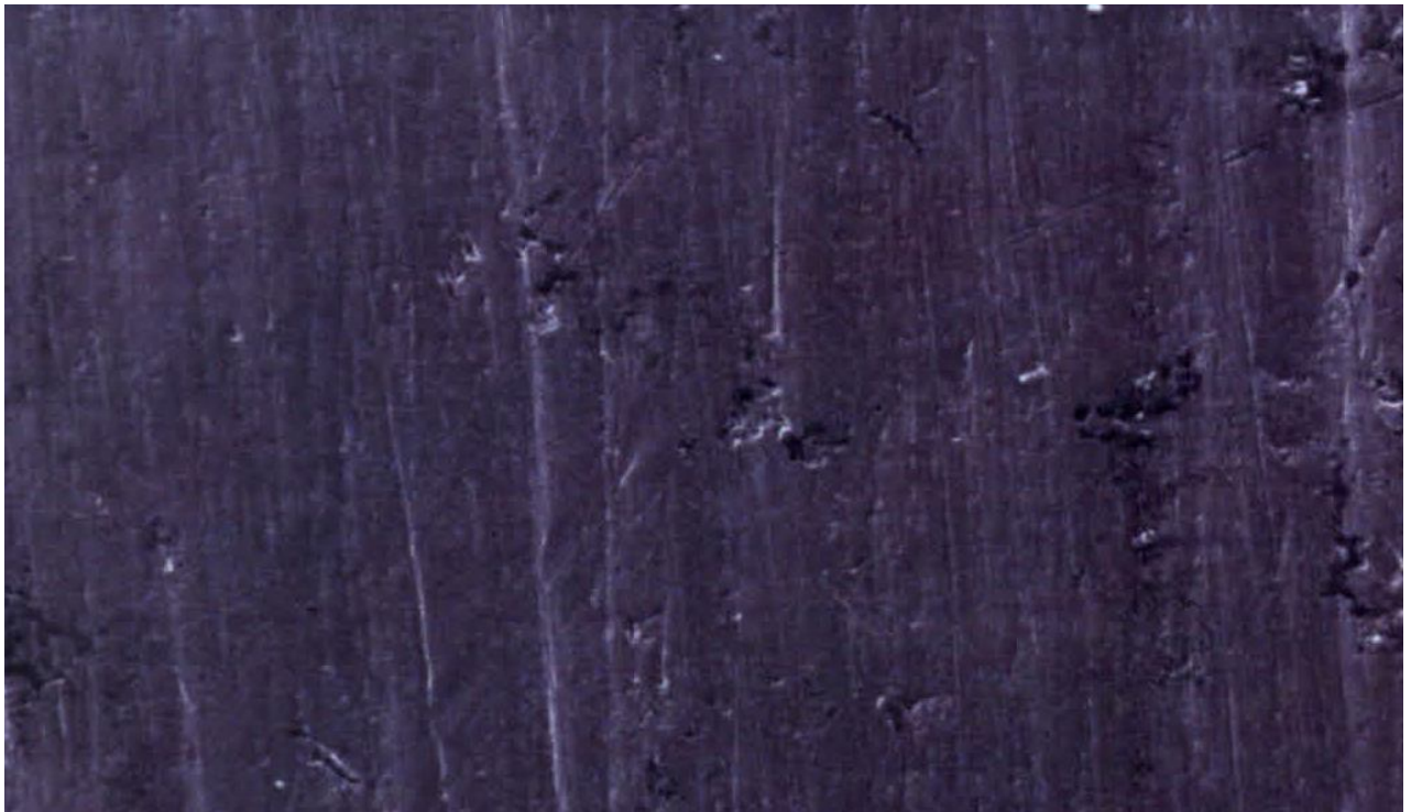
Рис. 3.3. Поверхня долота, яка зношувалась в умовах суглинкових та глинистих ґрунтів.
