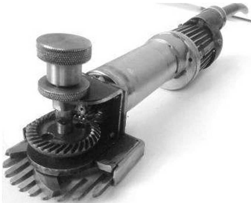
Рис. 3.2. Стригальна машинка ротаційного типу.
