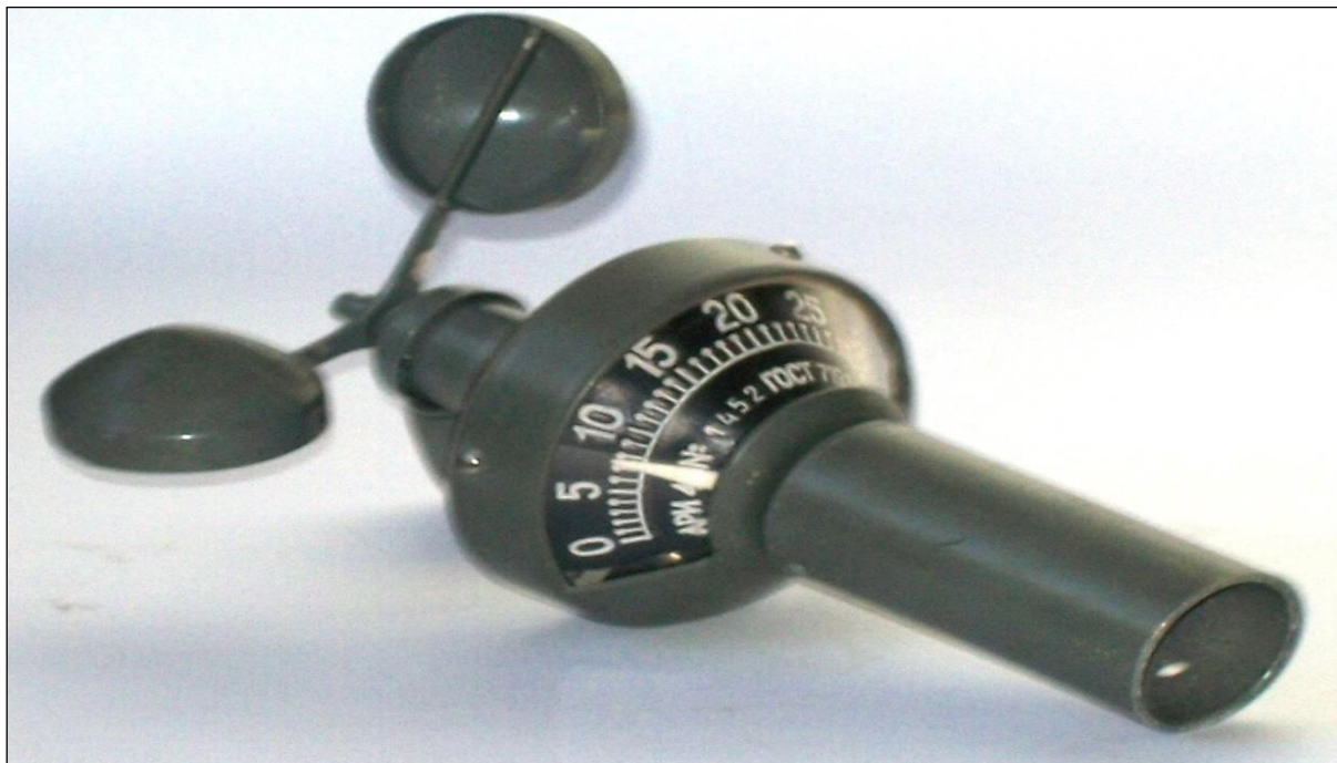
Рис 3.3. Анемометр ручний індукційний АРІ-49 [46, 47]
