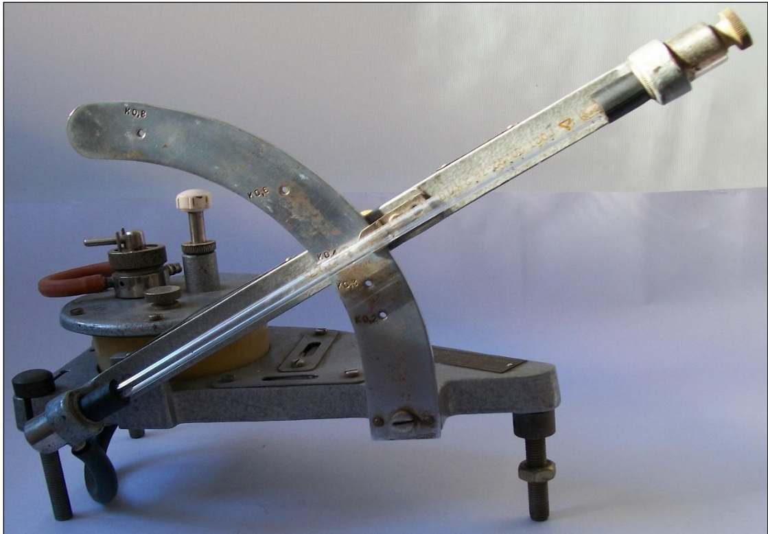
Рис. 3.4. Мікроманометр для вимірювання атмосферного тиску [46, 47]
