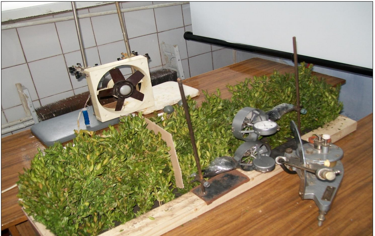
Рис 3.1. Модель-симулятор газо-пилізахисної смуги [49]
