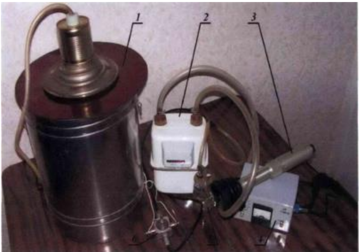
Рис. 2.2. Схема експериментальної установки: 1 – метантенк, 2 – газовий лічильник, 3 – газоаналізатор, 4 – датчик газоаналізатора, 5 - гідрозатвор, 6 - додатковий газовий розрядник
