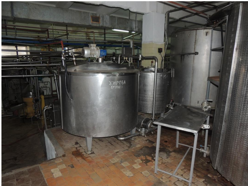
Рис. 10. Чан для змішування та отримання жирової емульсії
