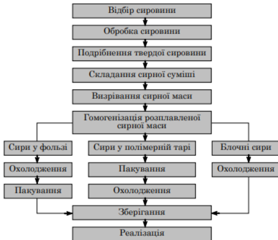
Рис.7. Технологічна схема виробництва плавленого сиру.
