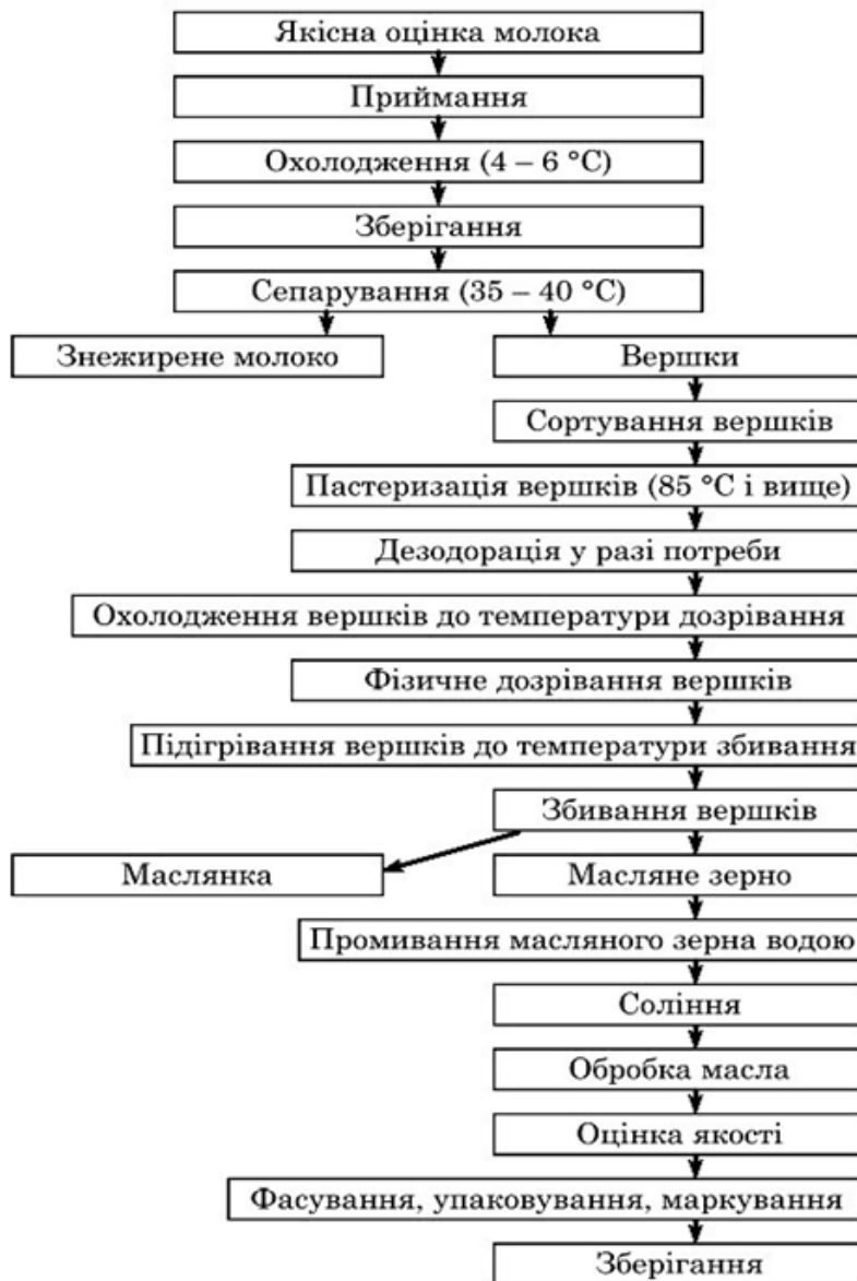
Рис. 2. Схема виробництва масла шляхом збивання вершків
