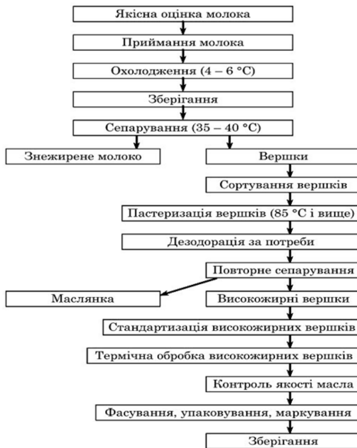
Рис. 1. Схема виробництва масла шляхом перетворення високожирних вершків
