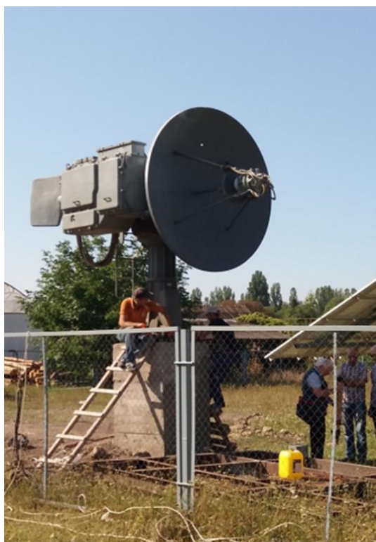
Рис. 3.2. Система приймання космічних даних середньої розподільчої здатності із антеною діаметром 2,5 м
