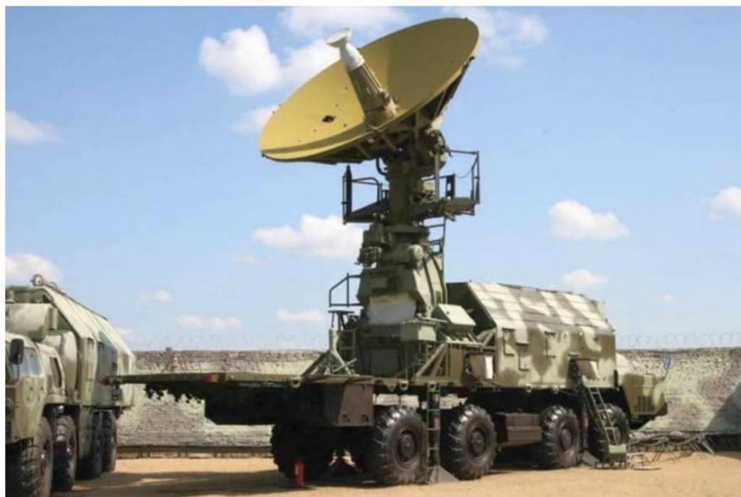
Рис. 3.3 Спеціальна система типу «Фазан» з антеною діаметром 5 м.
