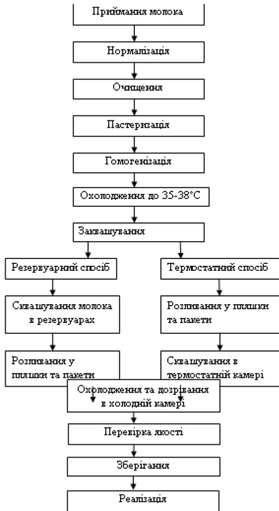
Рис.3. Схема технологічного процесу виробництва кефіру резервуарним та термостатним способом.
