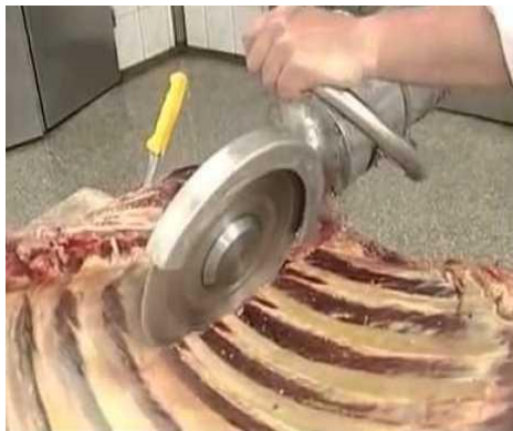
Рис. 3.3. Електрична пилка для розрубу туші
