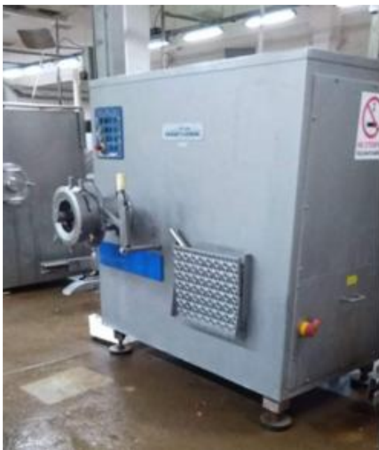
Рис. 3.8. Вовчок для крупного подрібнення сировини
