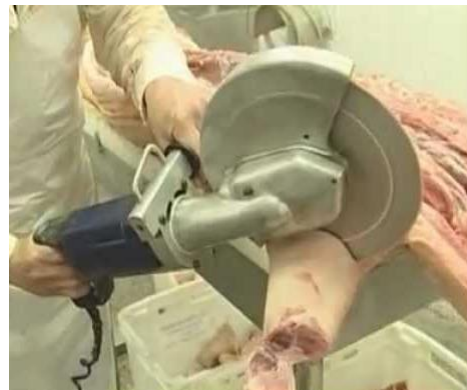
Рис. 3.3. Електрична пилка для розрубу туші
