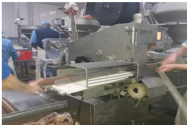
Рис. 3.13. Наповнення фаршем оболочок.
