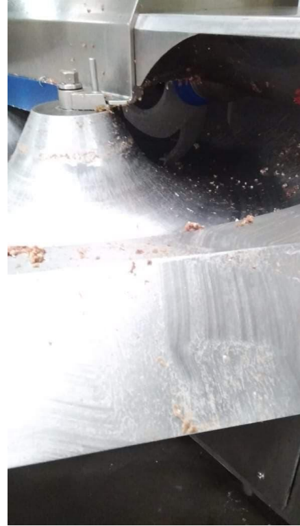
Рис. 3.11. Кутер та ніж, який використовується при виробництві сирокочених ковбас
