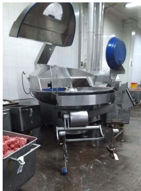
Рис. 3.9. Кутер для дрібного подрібнення сировини
