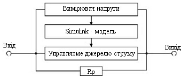
Рисунок – 1.1 Принципова модель нелінійного елемента (дуги)
