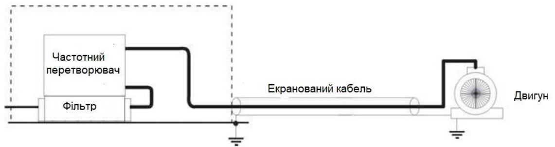
Рисунок 2.4. Схема установки захисного обладнання.
