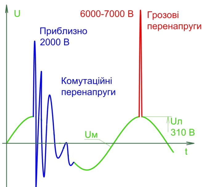
Рисунок 1.1 – Типові зовнішні та внутрішні перенапруги в мережах електропостачання
