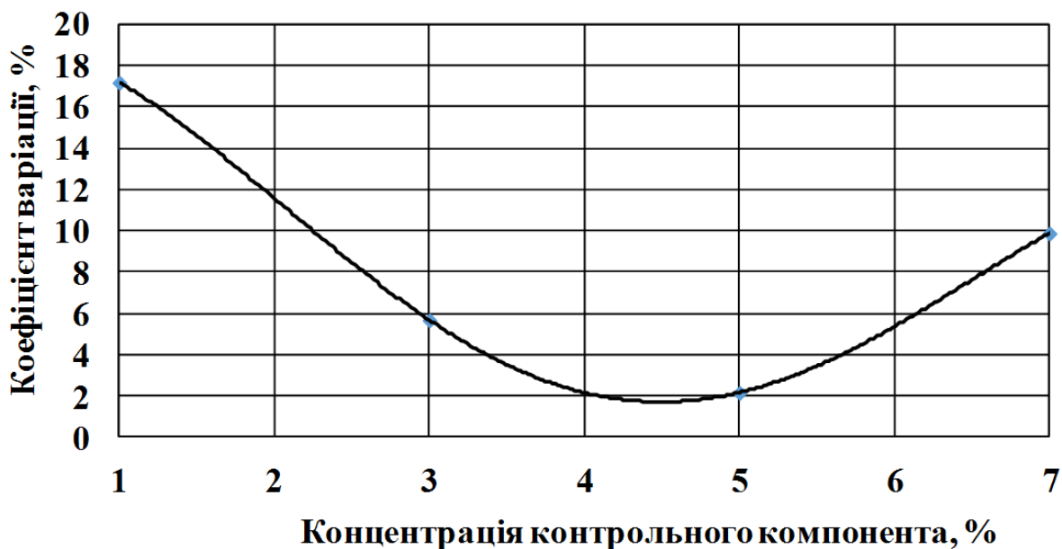
Рис. 2.И. Залежність якості змішування компонентів у субстраті від вмісту контрольного компонента в субстраті при частоті обертання \omega=1,05 рад/с, ступеню заповнення камери субстратом 50%, часу змішування 5 хв
