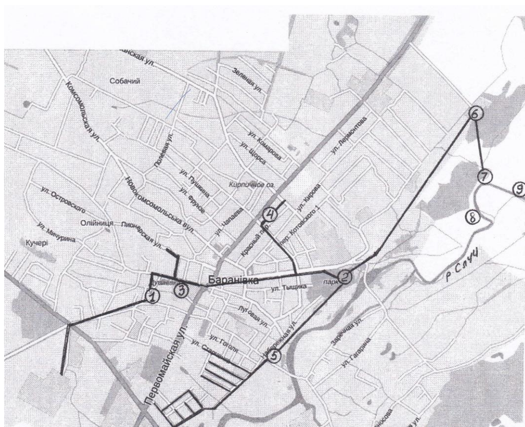
Рис. 3.9. Схема відведення стічних вод м. Баранівка з випуском у р. Случ: 1-5 – КНС 1-5, 6 – очисні споруди, 7 – випуск №1, 8 – місце відбору проб 500 м вище випуску, 9 – місце відбору проб 500 м нижче випуску
