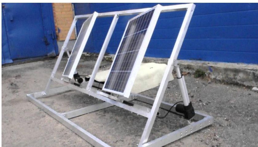
Фото Д 2.10 Трекерна система, в якій змінюється кути повороту панелей вертикально і системи панелей горизонтально.
