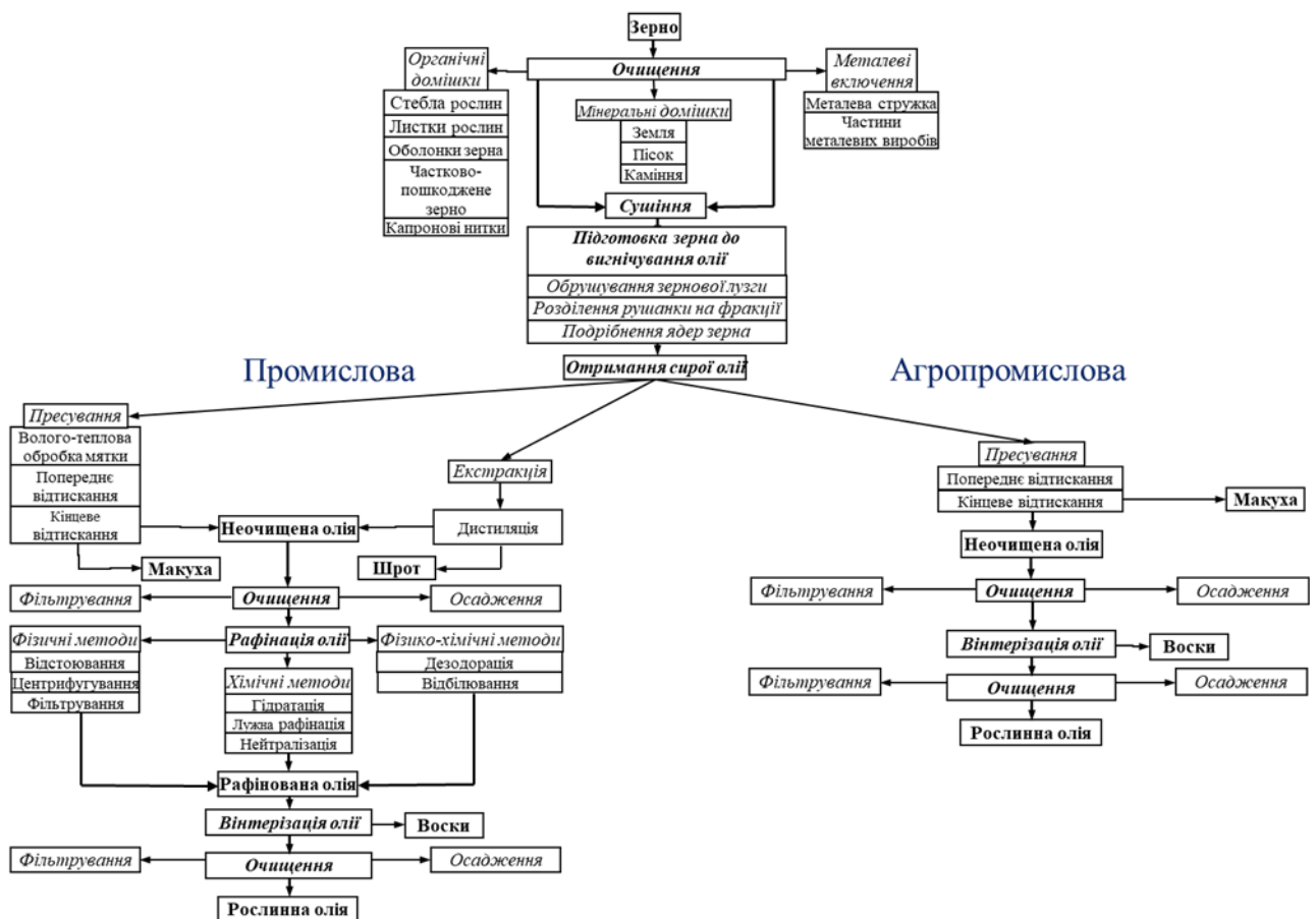
Рис. 2.1. Структура технологій виробництва олії [20, 23]
