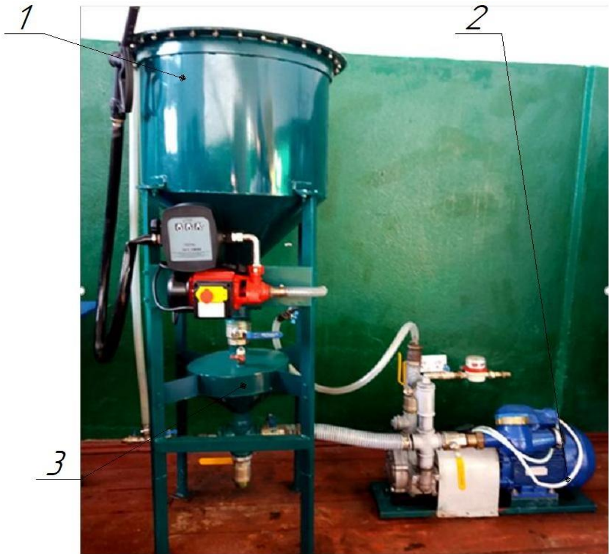
Рис. 3.1. Установка для отримання дизельного палива (реактор-відстійник): 1 – реактор, 2 – відстійник, 3 – станція для забезпечення циркуляції емульсії [24, 25].
