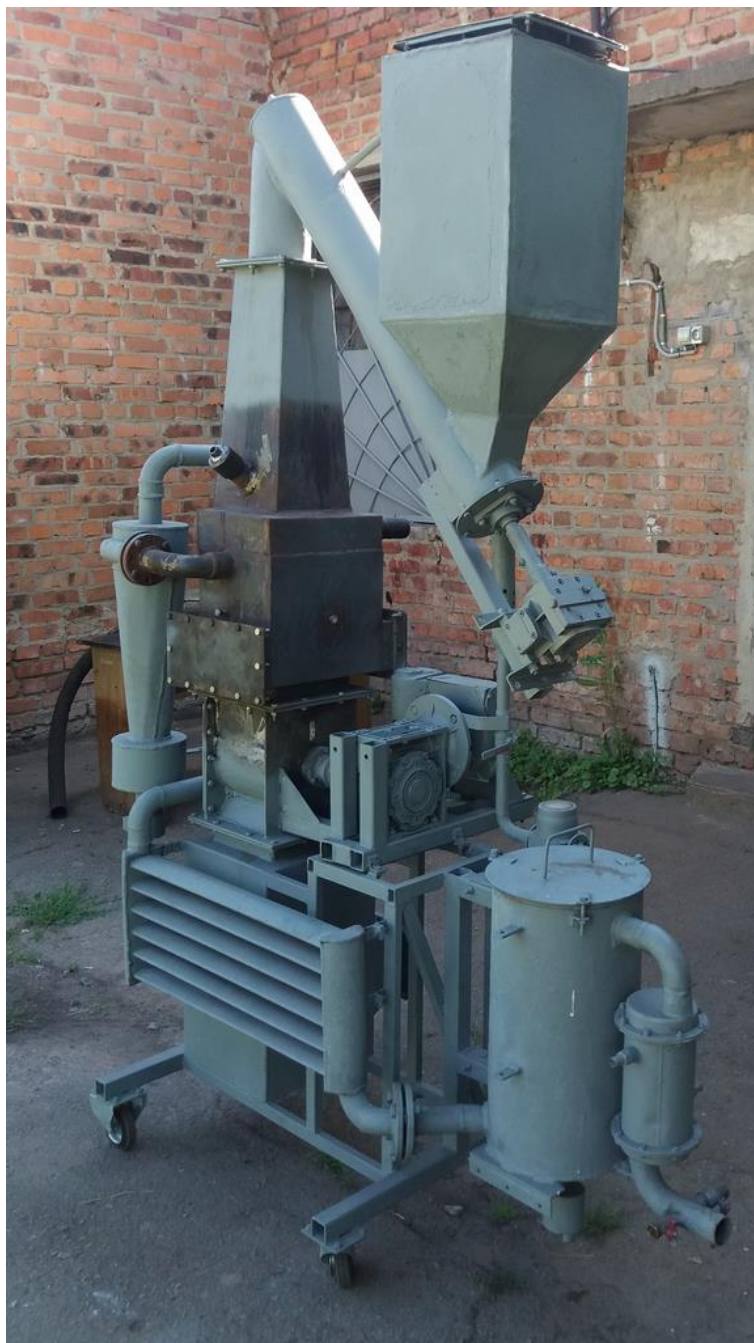
Рис. 2.2. Газогенератор для соломи розроблений науковцями Поліського національного університету
