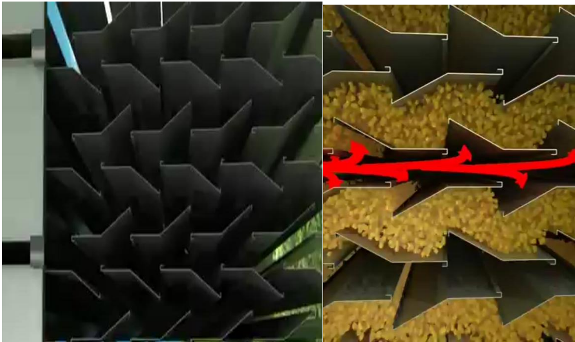
Рис. 2.3. Форма жалюзів при підлоговому вентиляванні
