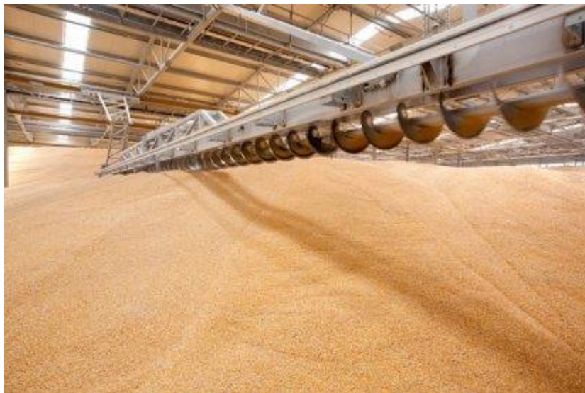
Рис. 1.2. Утворення зернового бурта в силосі з активним вентиляванням та перемішуванням
