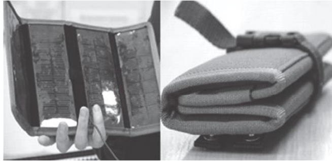
Рис. 1.2. Сонячна батарея розробки Національного університету ім. Т.Г. Шевченка
