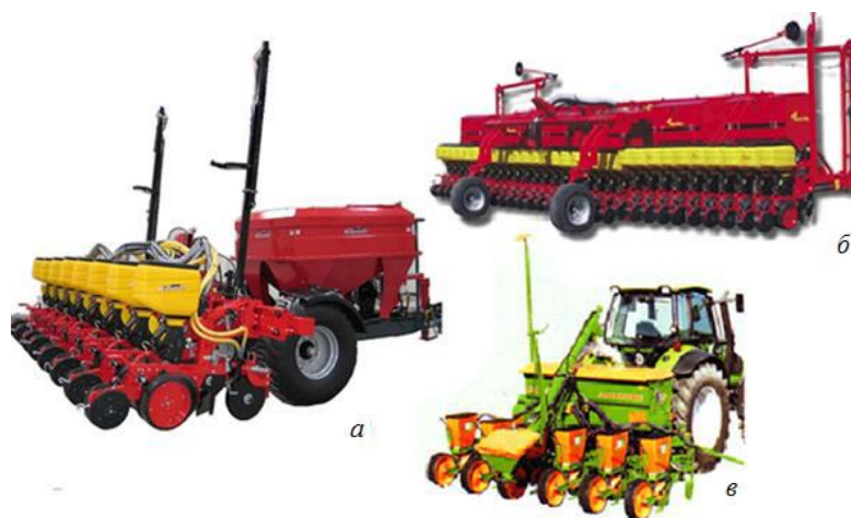
Рис. 1.3. – Пневматичні сівалки з центральним туковисівним бункером a і б – сівалки точної сівби «Hatzenbichler»; в – Сівалка пневматична серії ED фірми «Amazonen-Werke»
