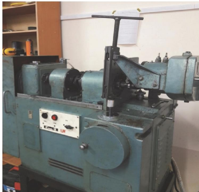
Рис. 2.3. Загальний вигляд машини тертя, яка використовувалась під час досліджень
