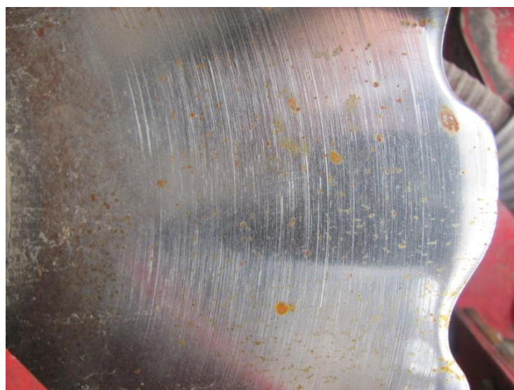
Рис. 3.7. Сліди від процесів мікрорізання робочої поверхні абразивними частинками ґрунту.
