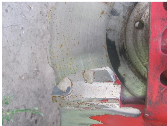
Рис. 3.6. Чистик сошника посівного комплексу Väderstad Rapid A 800 С.
