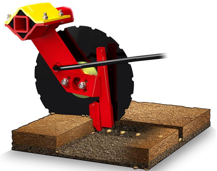
Рис. 2.2. Геометричні параметри (а) та принцип роботи (б) однодискового сошника посівного комплексу Väderstad Rapid A 800 C.
