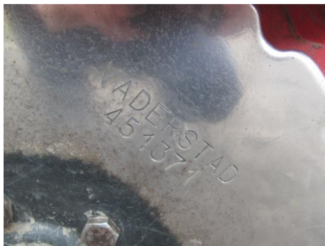
Рис. 3.8. Поверхня сошника посівного комплексу Väderstad Rapid A 800 С де переважаючим видом зношування є полі деформаційне руйнування.
