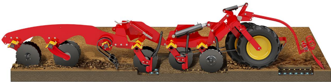
Рис. 2.1. Принцип дії посівного комплексу Väderstad Rapid A 800 C
